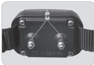
Obrázek upevnění testovací doutnavky
